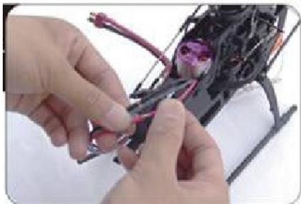
Находим провод и клемму идущие от двигателя.
