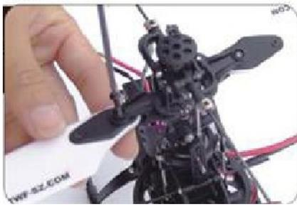
Устанавливаем верт на стол или другое место на возвышении, так чтобы удобно было к нему подлезть и отключить аккумуляторную батарею в экстренном случае, не цепляясь руками за движущиеся части. Крепим верт к столу за лыжи (струбциной или подкладываем что-нибудь тяжелое).
